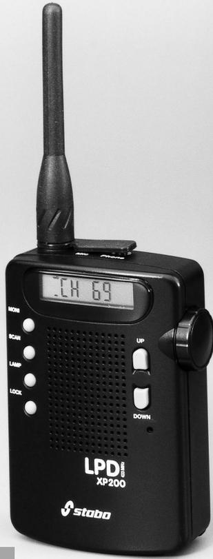
**Bild 3. Handfunkgerät für den 433-MHz-Bereich: 69 Kanäle im 25-kHz-Raster bei maximal 10 mW HF-Leistung und etwa 5 kHz Frequenzhub.**
